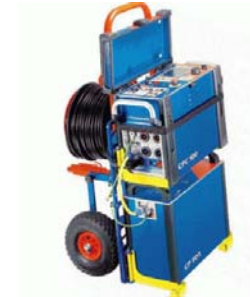
Imagen 1. Equipo de Prueba Omicron Testrano+TD1 para pruebas de Factor de Potencia y Capacitancia.
